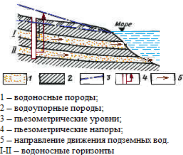
Рис. 1. Общая схема разгрузки подземных вод в море
